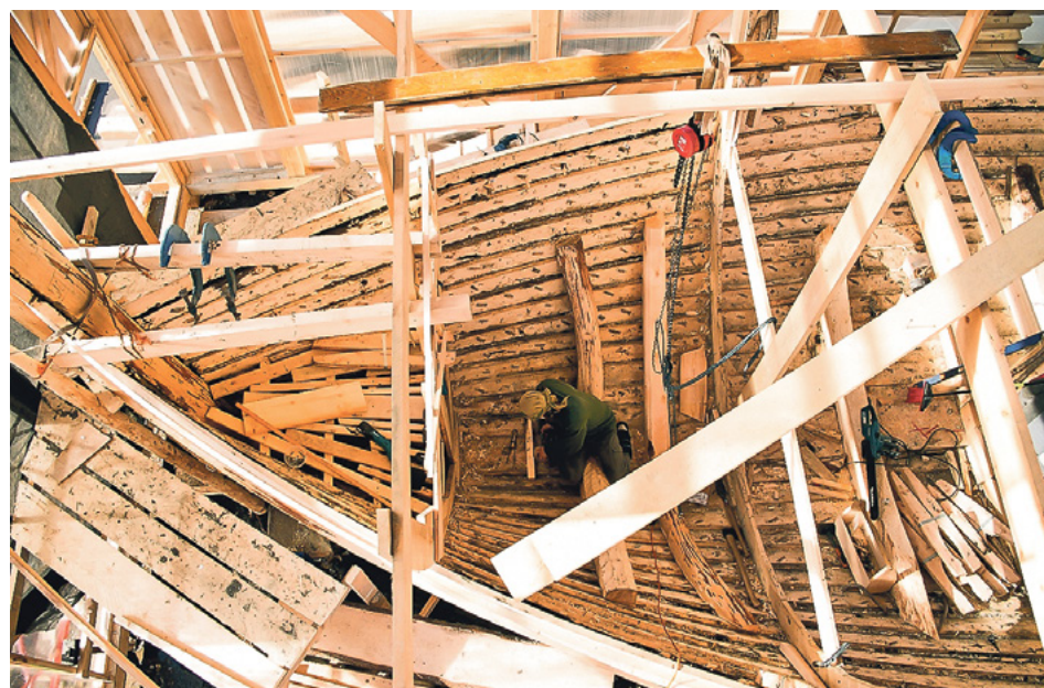
Строительство коча на верфи Товарищества поморского судостроения. 2026 год. Фото Екатерины Суворовой
